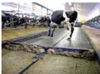
Fig. 39. Racletă – plug cu bară rigidă și tracțiune oliodinamică
