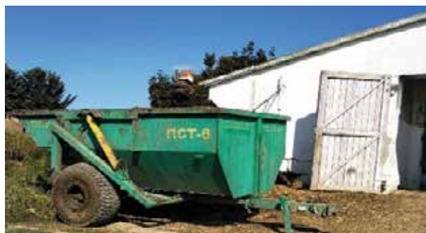
Fig. 38. Remorcă tehnologică pentru acumulare și transportul dejețiilor la depozit
