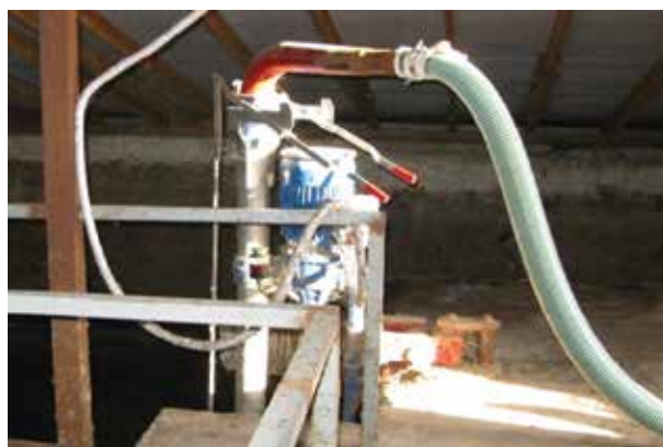
Fig. 51. Pompă centrifugale consola-monobloc de pompare a dejețiilor lichide
